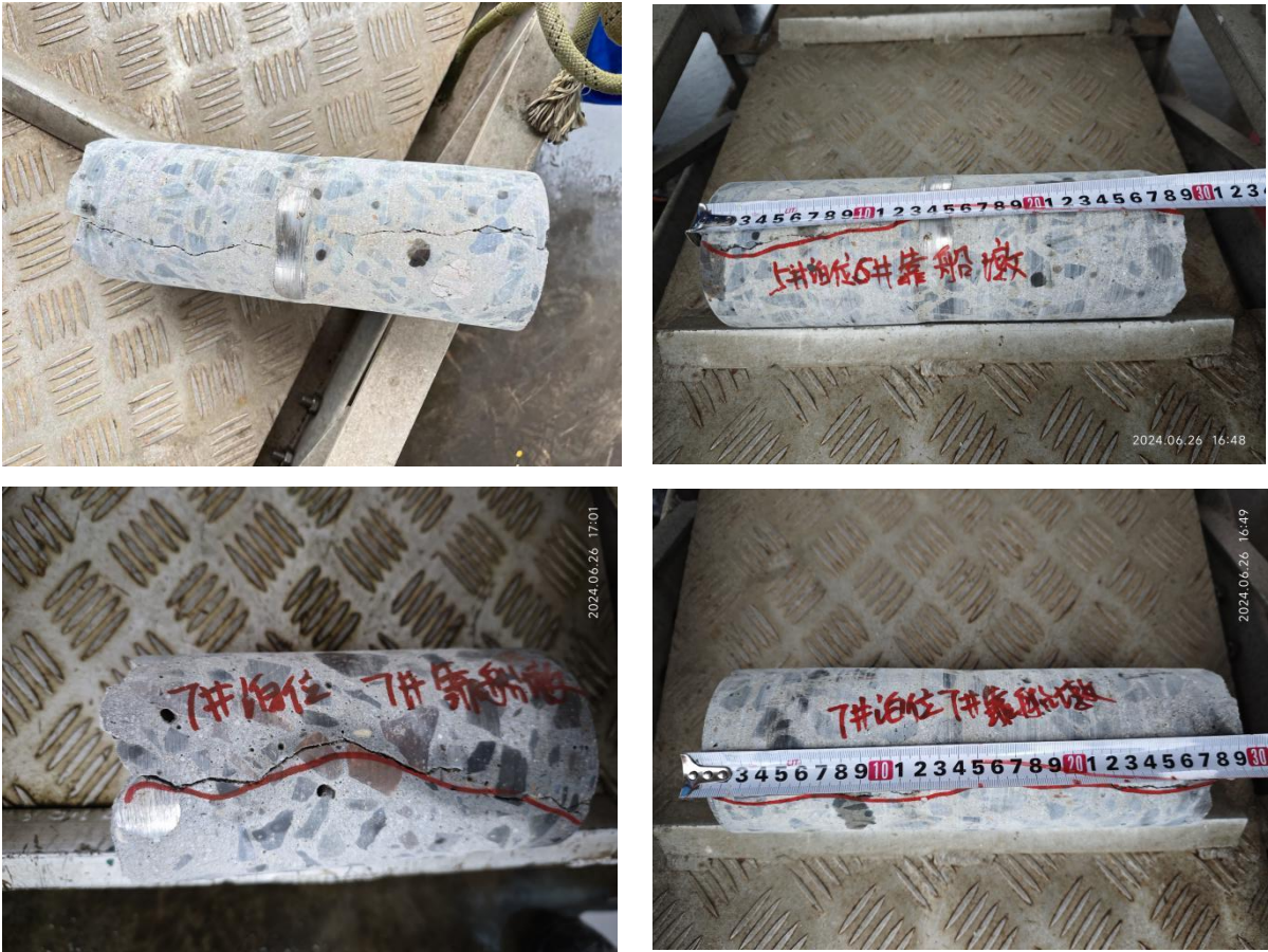
图 6-1 靠船墩裂缝现场取芯照片
